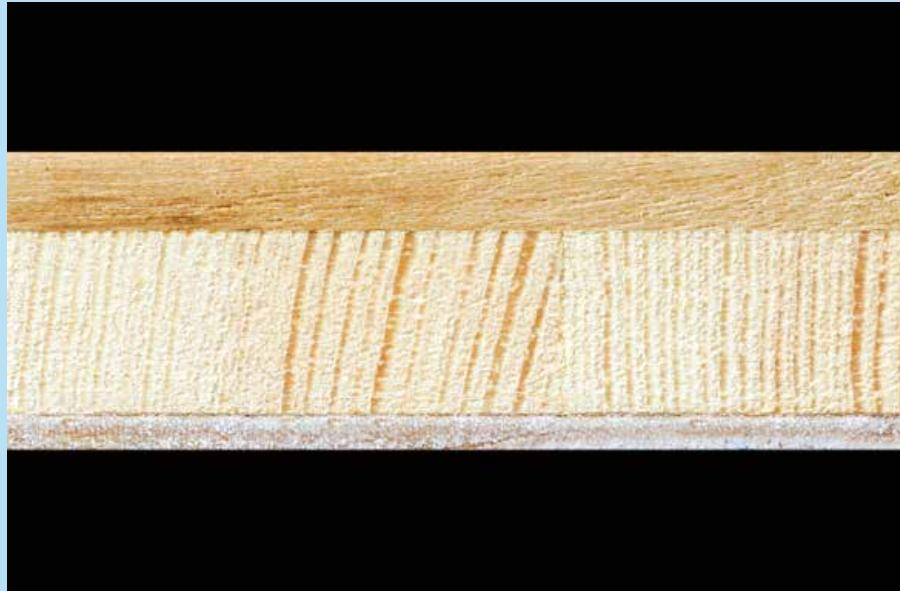
Deckschicht aus 3,8 mm massivem Hartholz.
