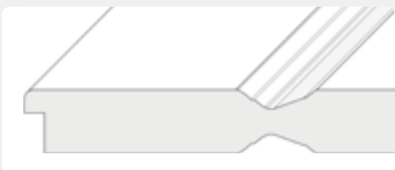
Türblatt mit liegenden Hohlprofilen, Einlage aus Röhrenspanplatten
