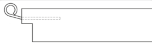
TGL-Tür mit Fitschenband – Querschnitt
